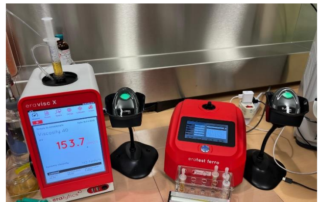
Figura 8: eravisc X e eratest ferro com leitor de código de barras individual
