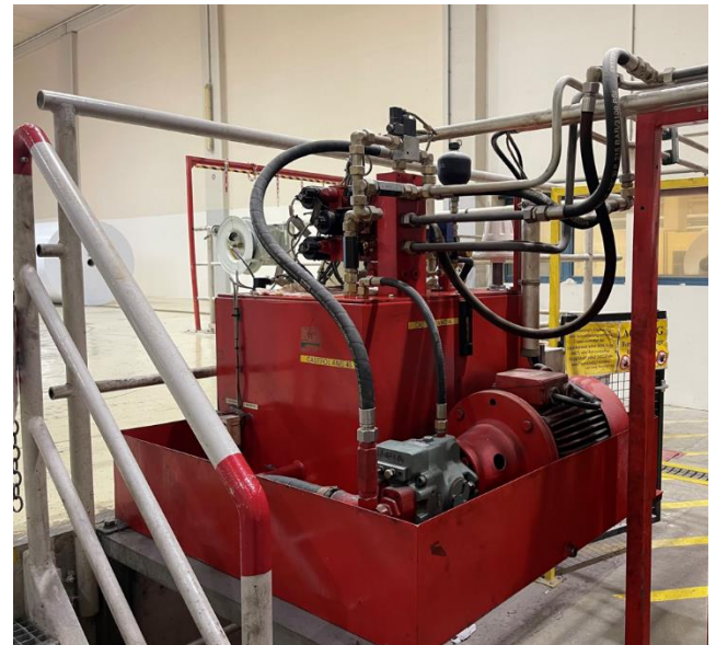
Figura 12: Sistema hidráulico - transferência de rolos
