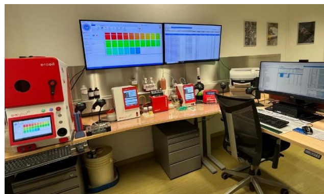
Figura 2: eralab OCM analisadores para monitorização interna da condição do óleo
